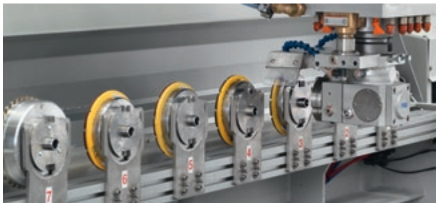
Magasin dédié au changement d'outil pour agrégat avec changement magnétique.
