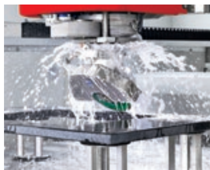
Coupe avec disque à 45° pour jonctions.
