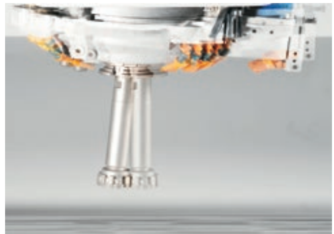
Axe T basculant ( \pm 2,5^\circ ) pour l'exécution de réductions avec plan incliné pour plan de cuisine.
