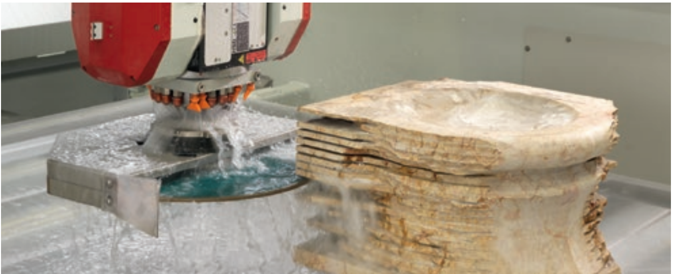
Découpe au disque selon n'importe quelle inclinaison.
