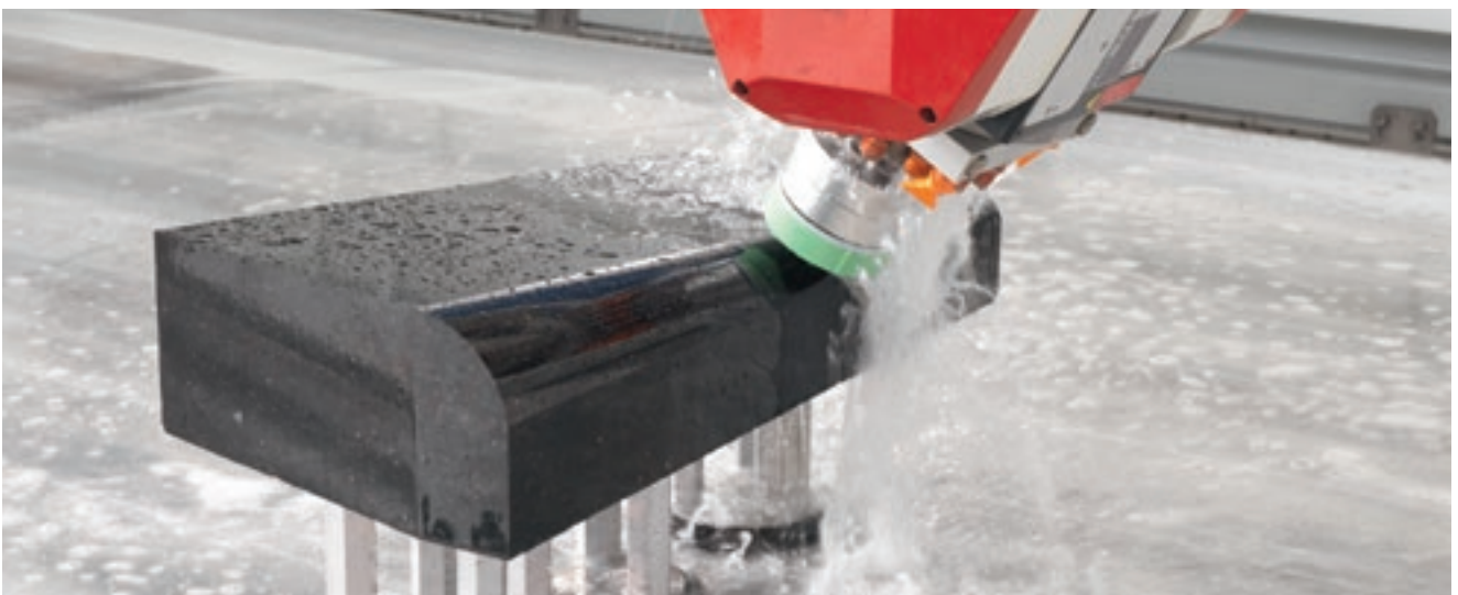
Polissage de profilés arrondis sur dalle.
