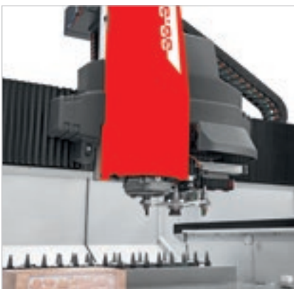
Magasin à bord de la tête rotative à 8 positions pour réduire les temps de remplacement des outils les plus utilisés.
